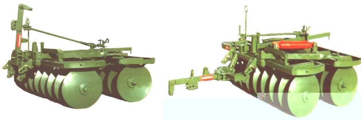
ERPICI FRANGIZOLLE A DISCHI PORTATI- TRAINATI (polverizzatori) a 2 sezione a "V"
